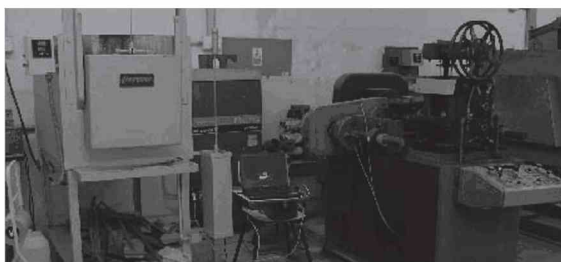
Fotografía del equipamiento utilizado para el proceso de deformación plástica por laminación. A la izquierda horno de precalentamiento, en el centro dispositivo de adquisición de temperatura y a la derecha el laminador.
