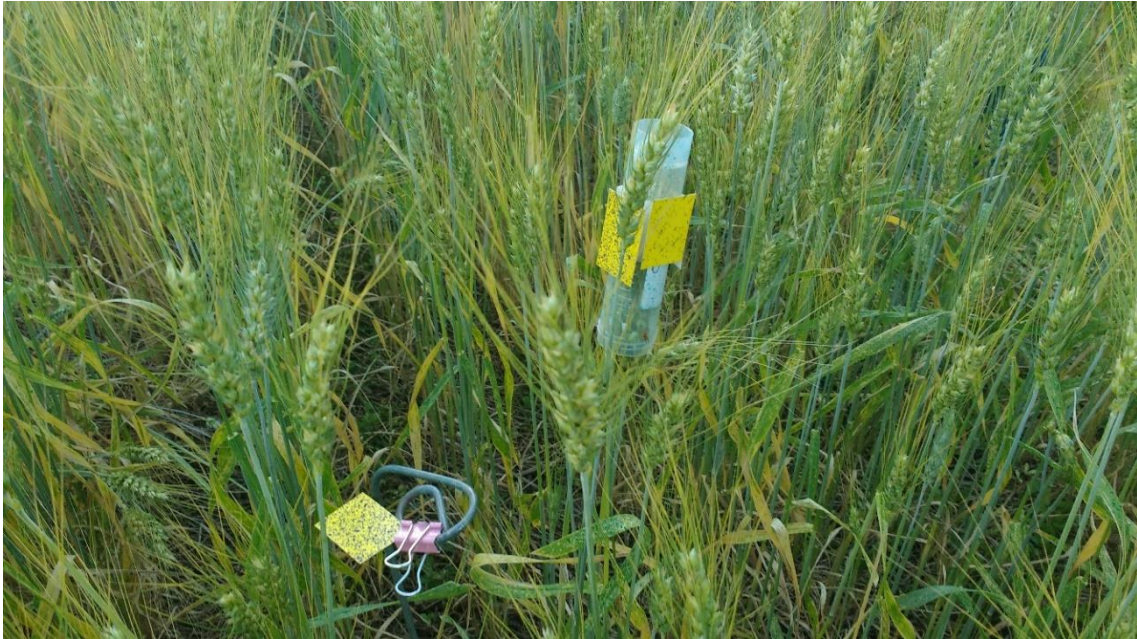
Figura 3. Disposición de las tarjetas hidrosensibles sobre el tubo cilindro y el soporte de hierro simulando la espiga y la hoja bandera, respectivamente.
