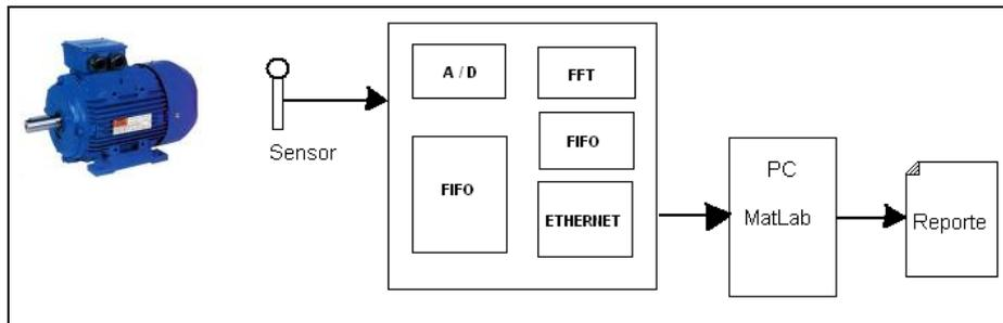
Fig 1. Diagrama de bloques del sistema analizado
