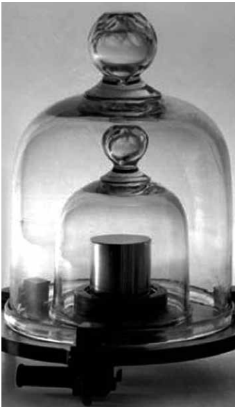
Fig. 6. El Prototipo Internacional del Kilogramo dentro de su doble alojamiento al vacío.
