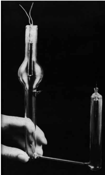
Fig. 16. La lámpara de ^{86}\text{Kr} .
