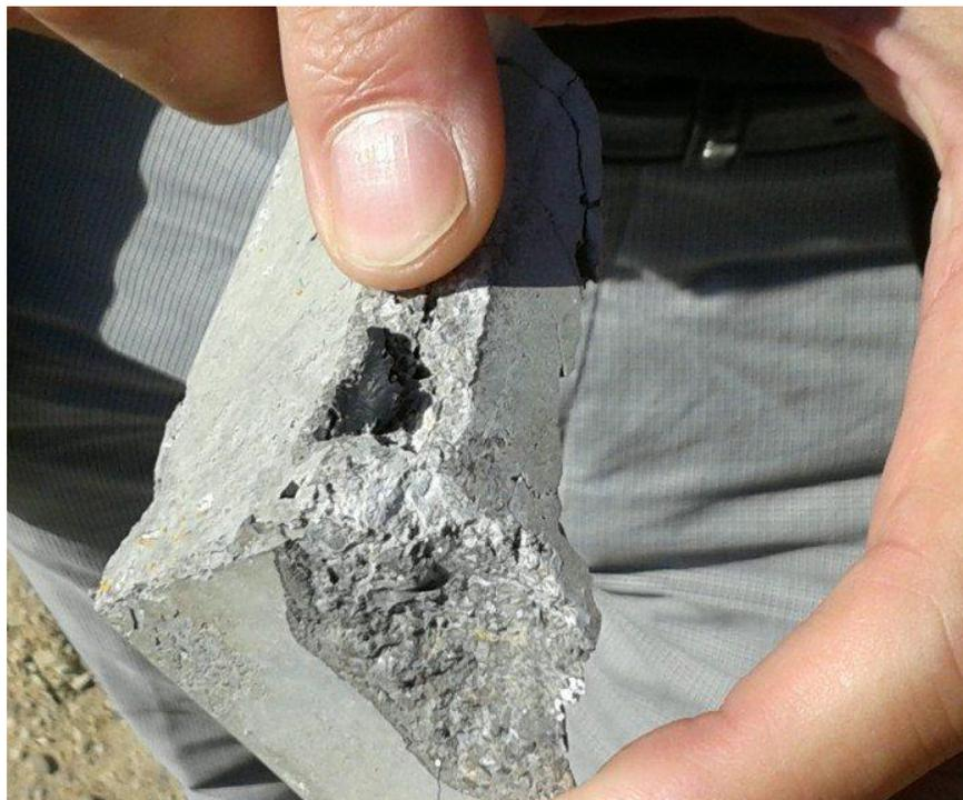
**Imagen 14:** Un trozo de caucho en el interior del cemento.
