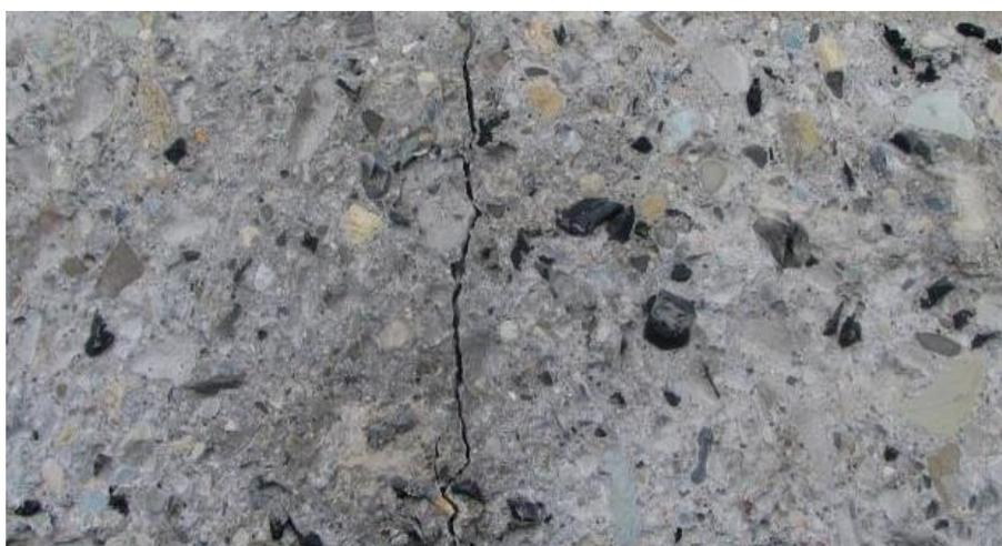
**Imagen 15:** Probeta de distribución de partículas de caucho en la matriz del hormigón.
