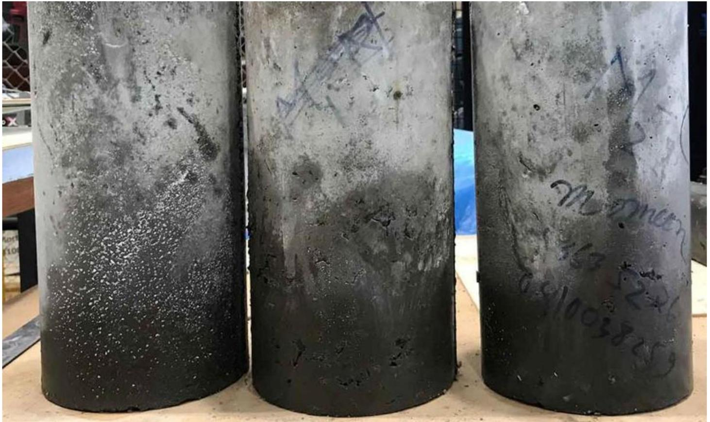
**Imagen 18:** Probetas de hormigón de caucho SBR-cemento para ensayos de tracción y compresión.
