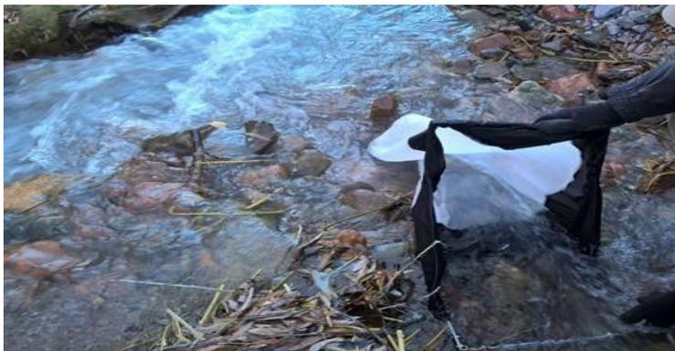
Figura 3.2.1 Toma de muestras de macroinvertebrados con red Surber
