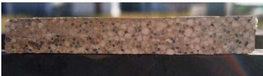
Figura 12: Corte de una de las partes del ladrillo Puma Punku.
