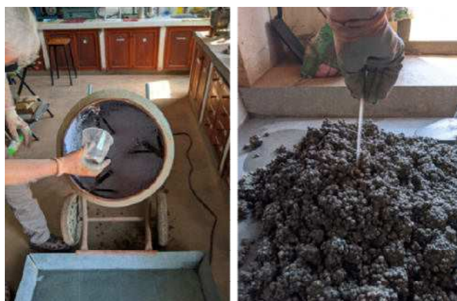
Figura. 8: A la izquierda agregados de ARLINC y a la derecha toma de temperatura.
