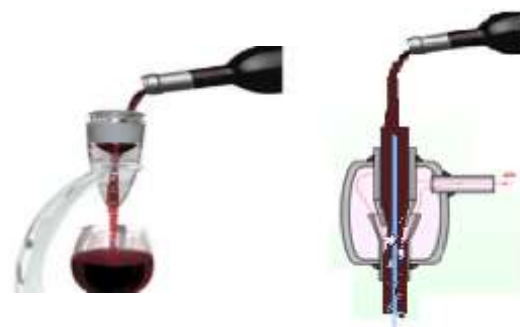
Figura 5. A la izquierda, el aireador de vino y a la derecha, un esquema de su funcionamiento.
