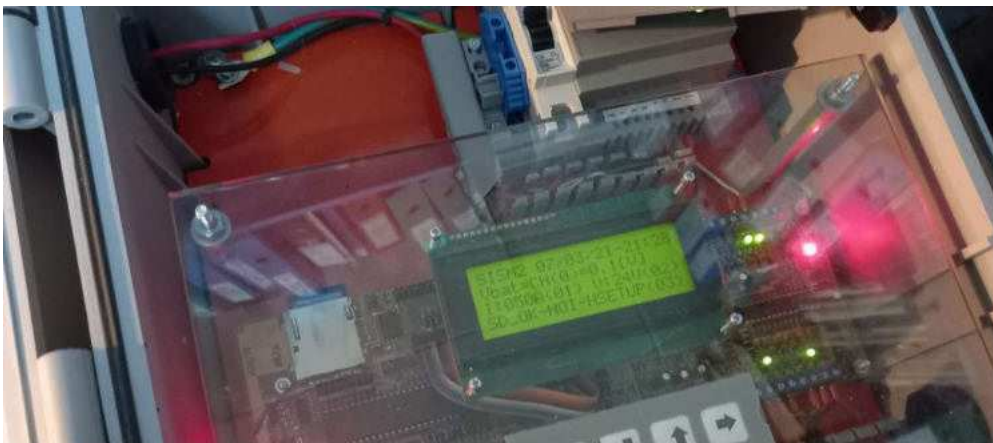
Figura 9: Ensayos luego de la incorporación del Bootloader al SISMED/SJ24 en 2021 (sin sensor de voltaje conectado). Debajo del panel a la izquierda se aprecia la placa CL2, a la derecha la M4/E.
