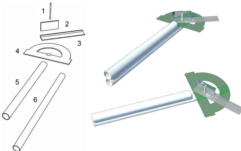
Está pensado para medir ángulos en planos más o menos horizontales. Son dos tubos por los que el observador puede mirar casi simultáneamente dos objetos, por el tubo de abajo mira directamente un objeto, por el de arriba mira el reflejo en un espejo del otro objeto.
