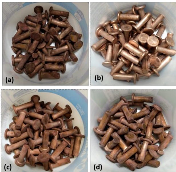
Figura 2: Remaches cobreados en tambor rotatorio (a) sin aditivo (b) TEPA (c) PQ-7 (d) PQ-2
