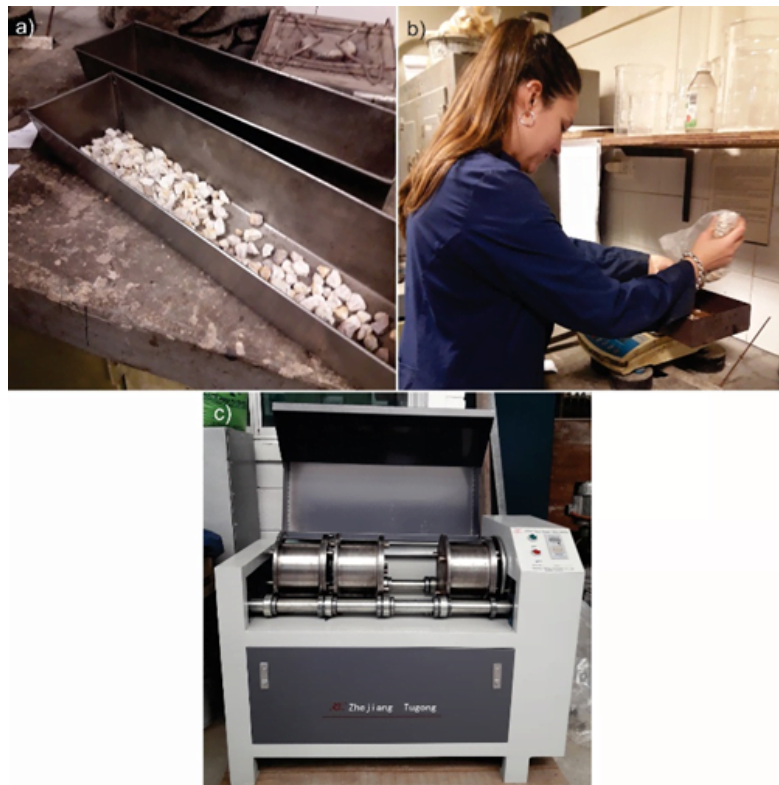
FIGURA 2 a) Material cuarteado. b) Pesaje del material. c) Equipo para el ensayo Micro Deval, LEMaC
