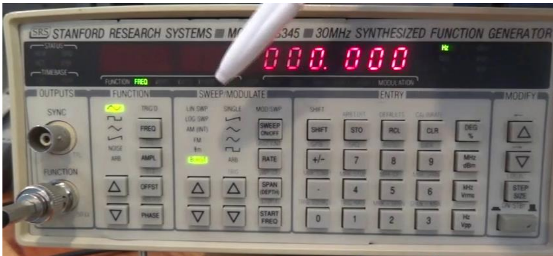
Ilustración 37: Generador de señales digital
