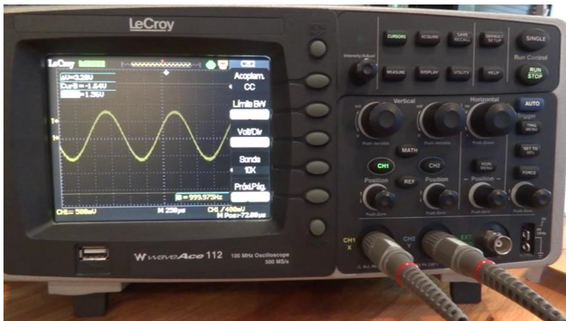
Ilustración39: Osciloscopio digital utilizado en los laboratorios virtuales
