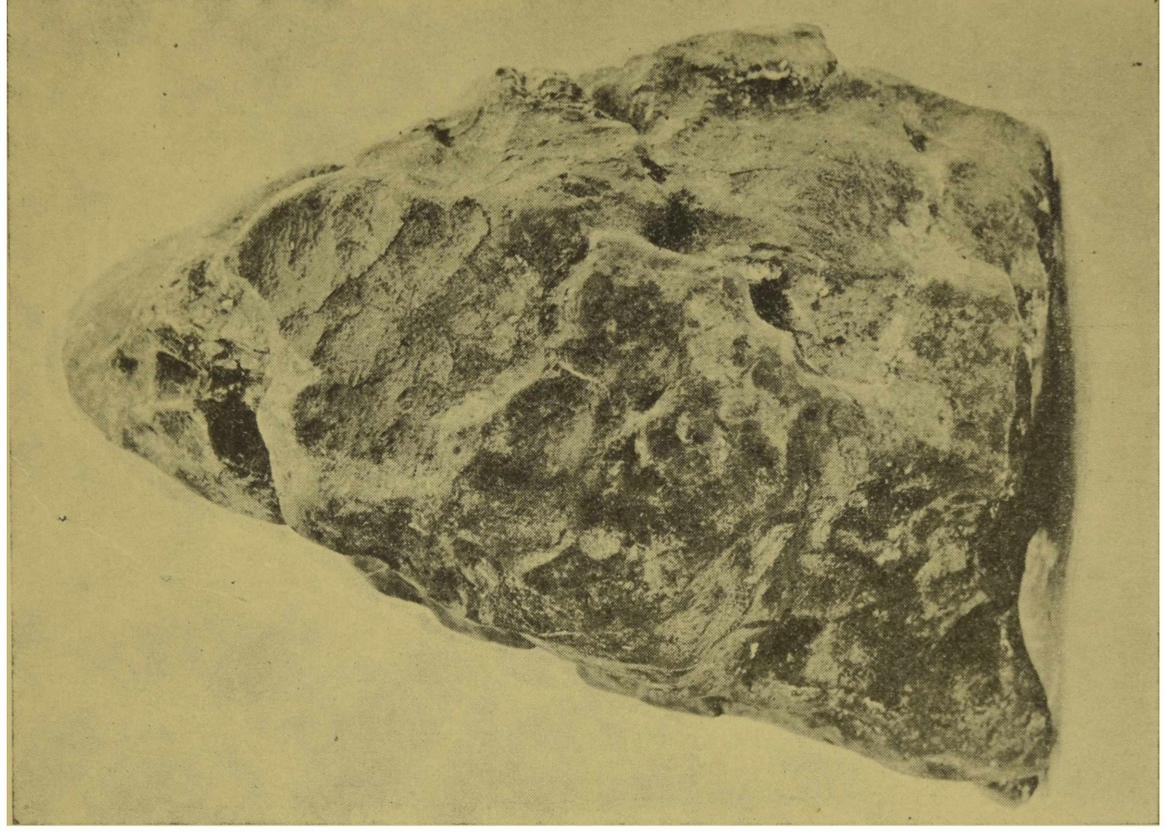
Fig. 2. -- Cara bastante plana con grietas profundas producidas por el choque muy probablemente.
