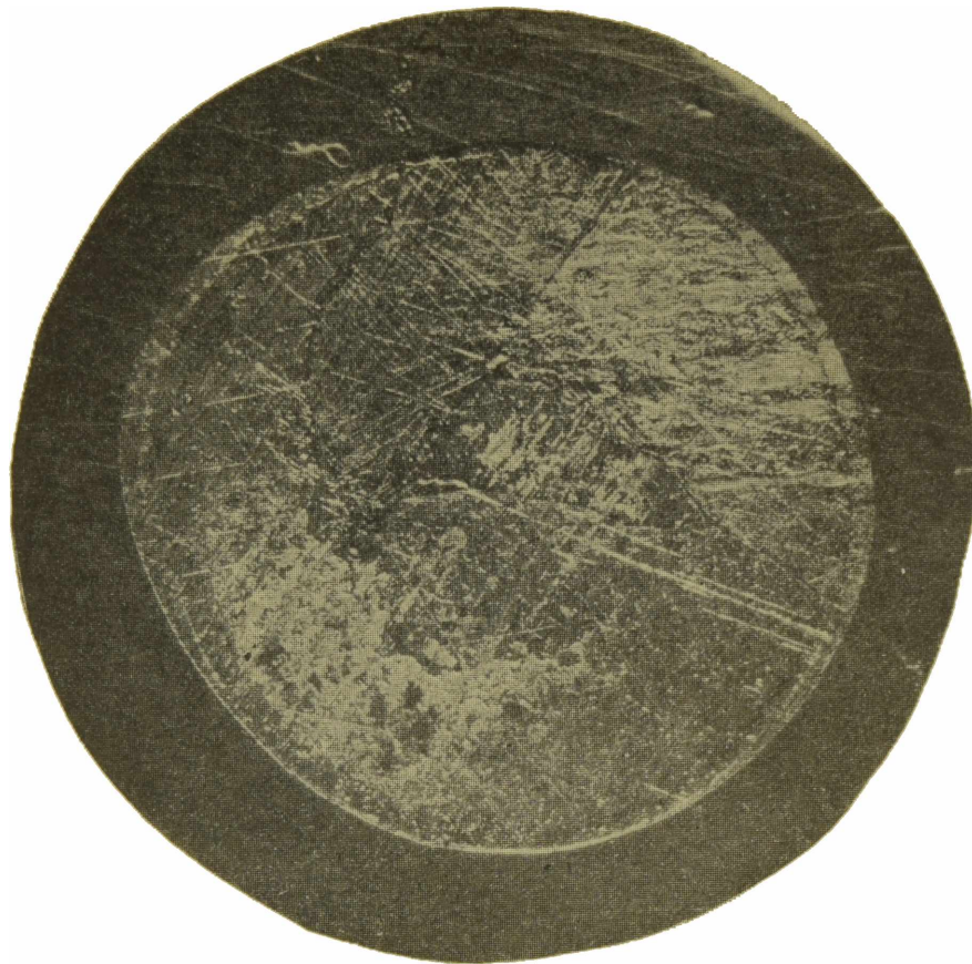
FIG. 3. — Figuras de corrosión vistas con escaso aumento (10 diám.).
