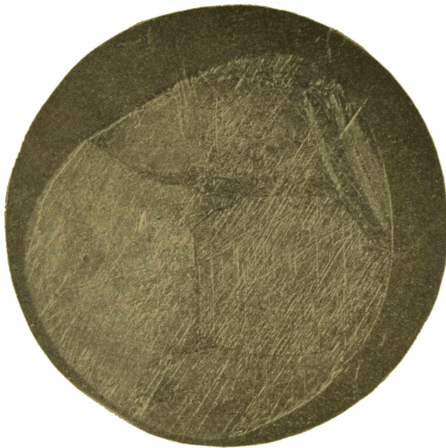
FIG. 5. —Individuos diferentes atacados simultáneamente, para comprobar su diferente orientación.
