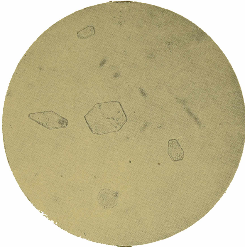
Fig. 9. — Cristales de aspecto rómbico, incoloros. En luz polarizada birrefringentes, con hermosos tintes de polarización.
