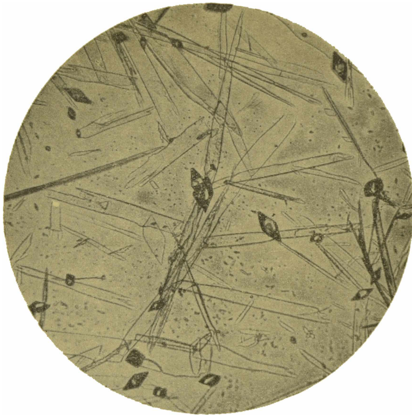
Fig. 6 Cristales incoloros de la preparación N° 1. Con luz polarizada muestran birrefringencia.
