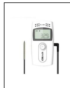
Fig.40 : Datalogger a ser usado para toma de mediciones en dormitorio y sala-comedor-estudio.
