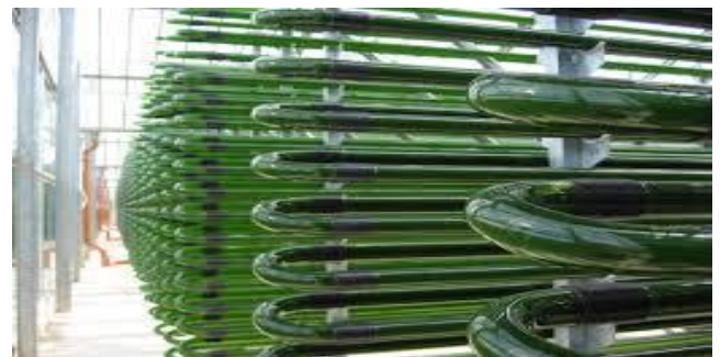
Fig. 1. Fotografía de un fotobiorreactor tubular con iluminación natural.
