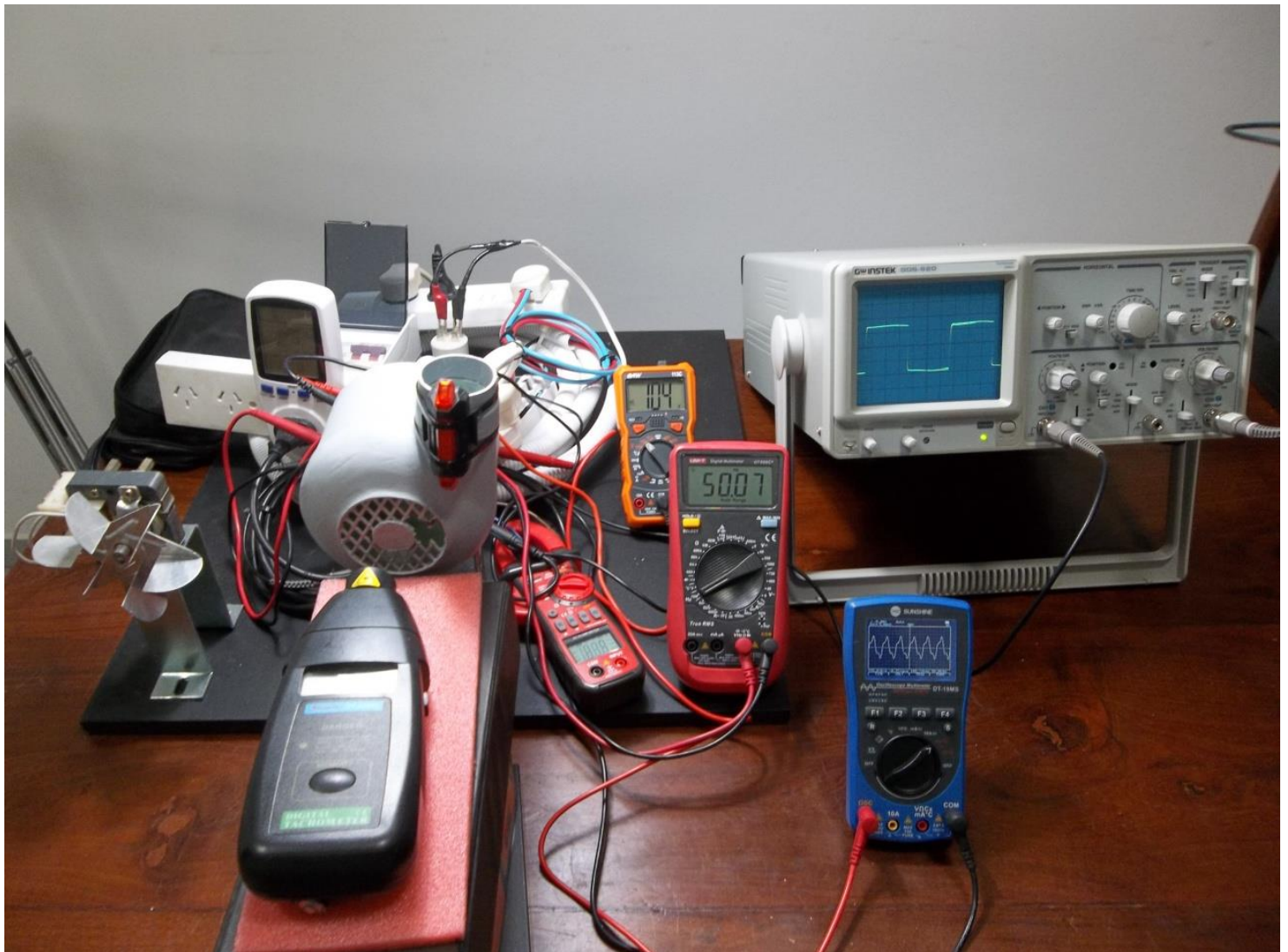
Imagen 4. Banco de pruebas conectado al motor extractor/soplador centrífugo de aire viciado de SARS-CoV-2 o Covid-19 (Coronavirus): Turbo. Con multímetro digital (medidor de voltios en AC), pinza amperométrica (medidor de intensidad de la corriente en AC), frecuencímetro (medidor de Hertz), fotocómetro láser (medidor de velocidad en RPM), osciloscopio digital medidor de la forma de onda de la corriente alterna en tensión ( V_{pico} , V_{avg} , V_{rms} ), para cálculo de factor de cresta de distorsión armónica, osciloscopio analógico para observación cualitativa de la THD (distorsión armónica de la corriente alterna), vatímetro (medidor de potencia
