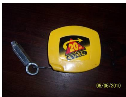
Figura 6. Cinta métrica adaptada para medición de nivel freático.
