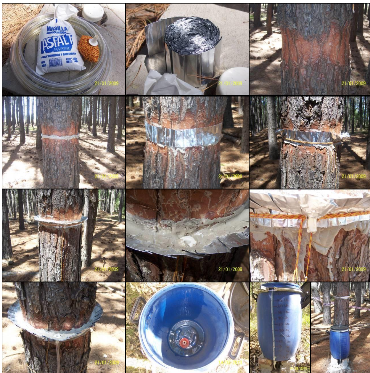
Figura 8: Secuencia de imágenes (de arriba hacia abajo y de izquierda a derecha) indicando la instalación de un colector de flujo caulinar en un árbol de pino.
