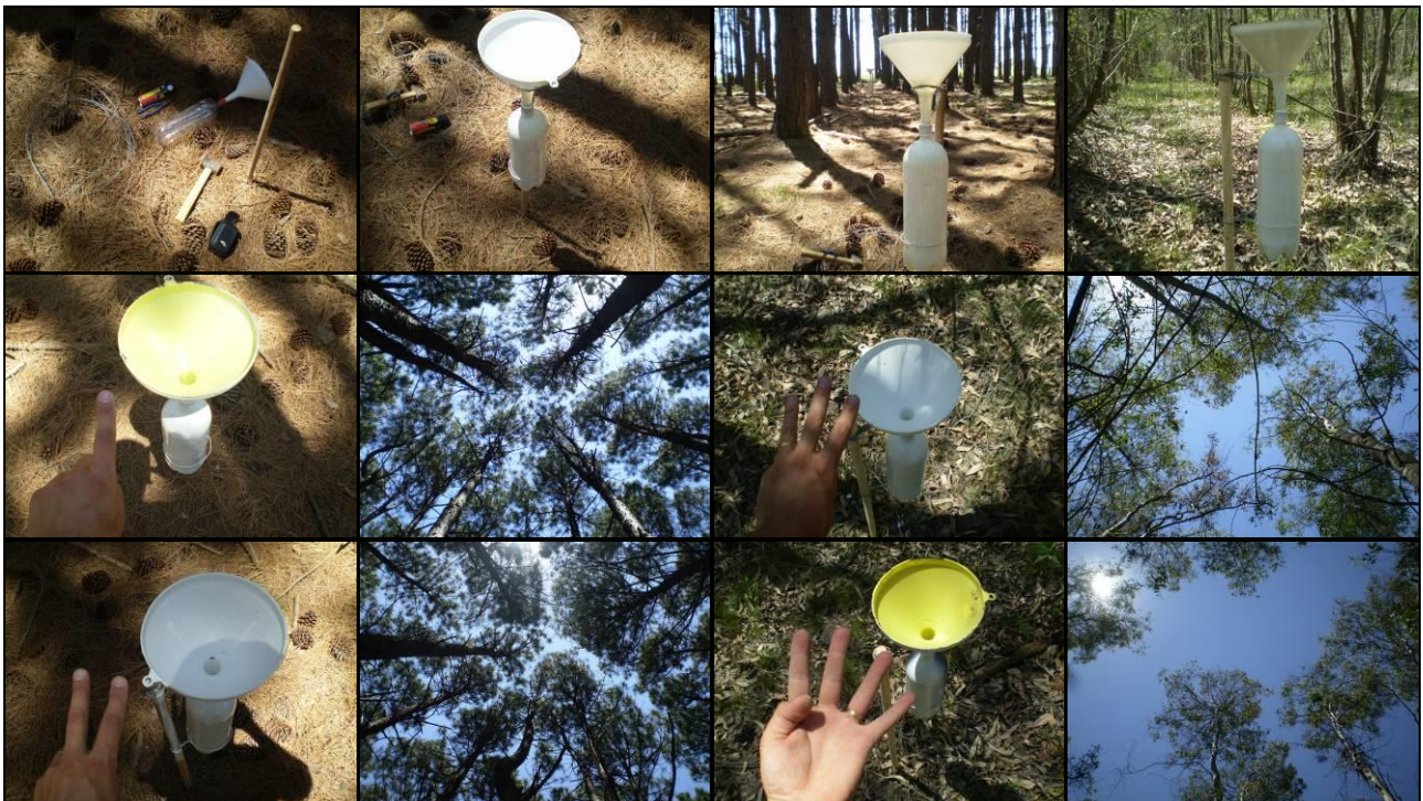
Figura 9: Secuencia de imágenes mostrando el instrumental necesario para la fabricación de los pluviómetros, una vista lateral en cada uno de los rodales y la cobertura forestal sobre cada uno de ellos.
