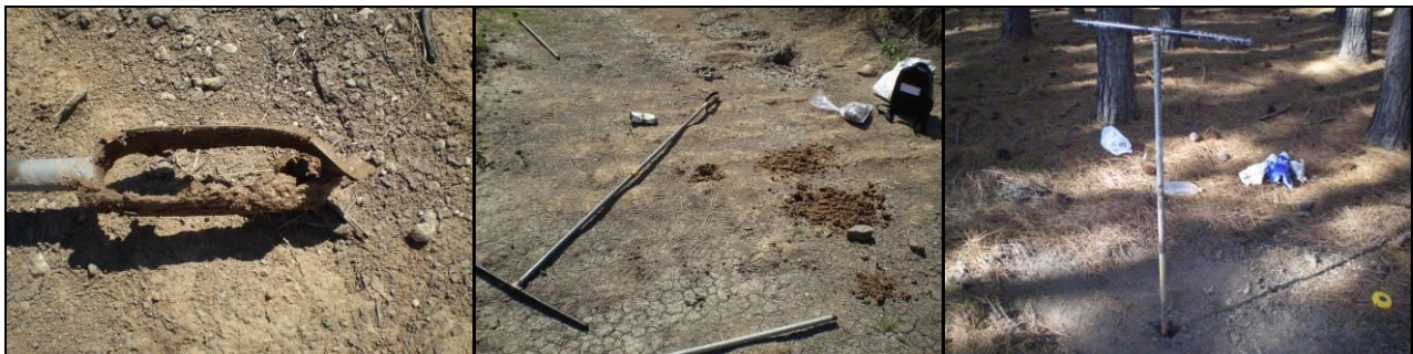
Figura 12. Barreno de mano tipo Edelman con tramos múltiples de 1 m de largo cada uno.
