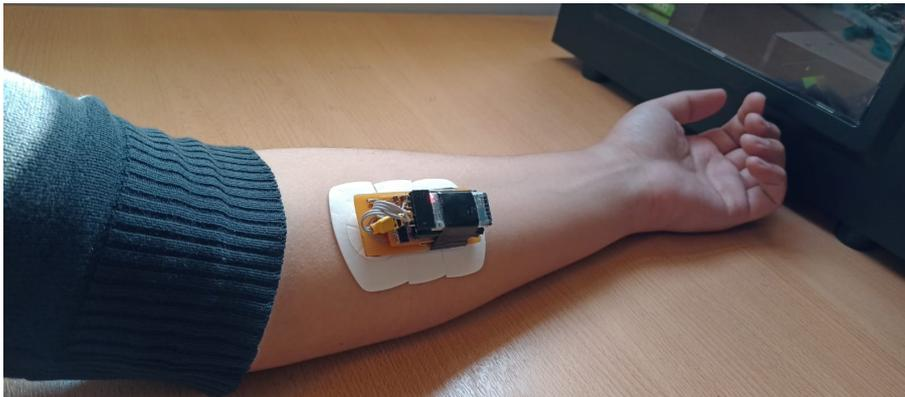
Figura 6.12: Sensor portátil fabricado con el amplificador doble-diferencial propuesto colocado en el antebrazo de un usuario.
