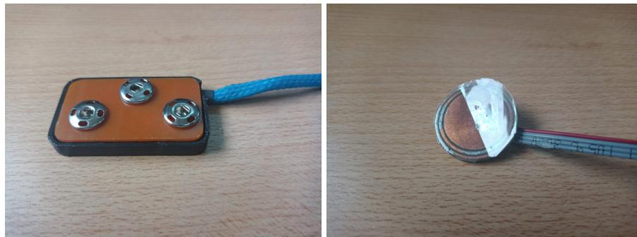
(c) Electrodo seco que no requiere tratamiento de la piel. (d) Electrodo capacitivo que mide a través de un dieléctrico transparente.
