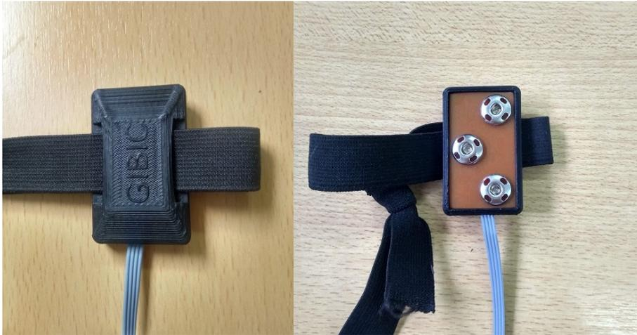
Figura 4.6: Prototipo final del sensor implementado.
