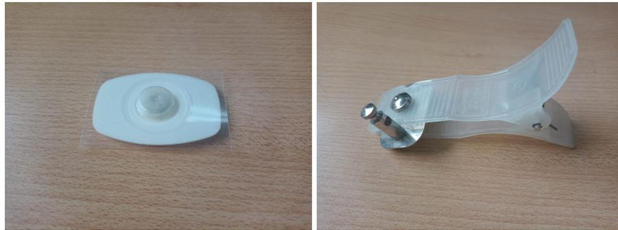
(a) Electrodo húmedo con gel conductor incorporado. (b) Electrodo seco que requiere limpieza y contacto de la piel con alcohol.
