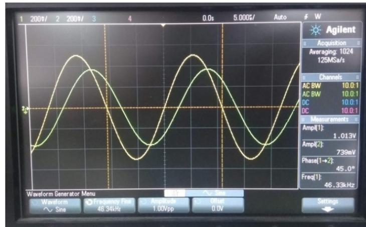
Figura 3.14: Señales de entrada y salida del circuito con bootstrap de fuente. Se observa que presenta una atenuación de 3 dB y un desfase de  $45^\circ$  a una frecuencia de 46,3 kHz.
