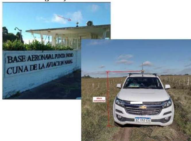
Figura 3: Campaña de relevamiento GNSS. estación Base y móvil montado en el vehículo.
