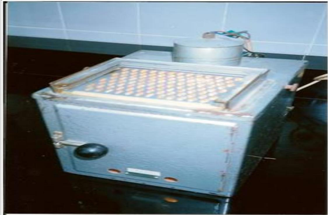
*Fig. 13.5. Medición de la vitreosidad por método diafanoscopio en la Chacra Experimental Integrada de Barrow.
