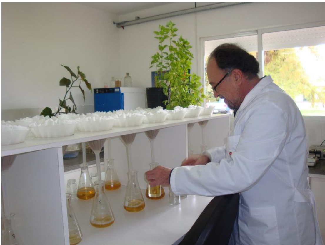
Fig. 19.8. Filtrado del mosto. Laboratorio de Calidad de Cebada y Malta. Mejoramiento y Calidad Vegetal-INTA Estación Experimental Agropecuaria Bordenave. Foto gentileza Dra. Ing. Agr. Verónica Conti
