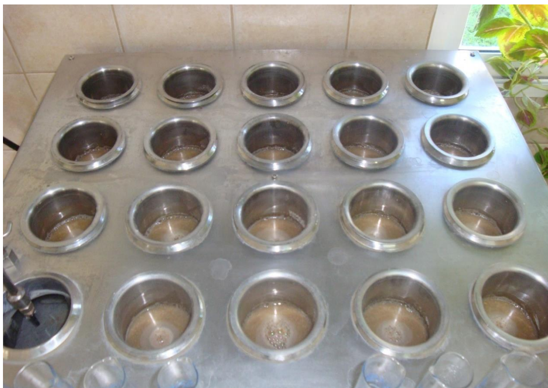
Fig. 19.7. Maceración de la malta molida. Laboratorio de Calidad de Cebada y Malta. Mejoramiento y Calidad Vegetal- INTA Estación Experimental Agropecuaria Bordenave. Foto gentileza Dra. Ing. Agr. Verónica Conti.
