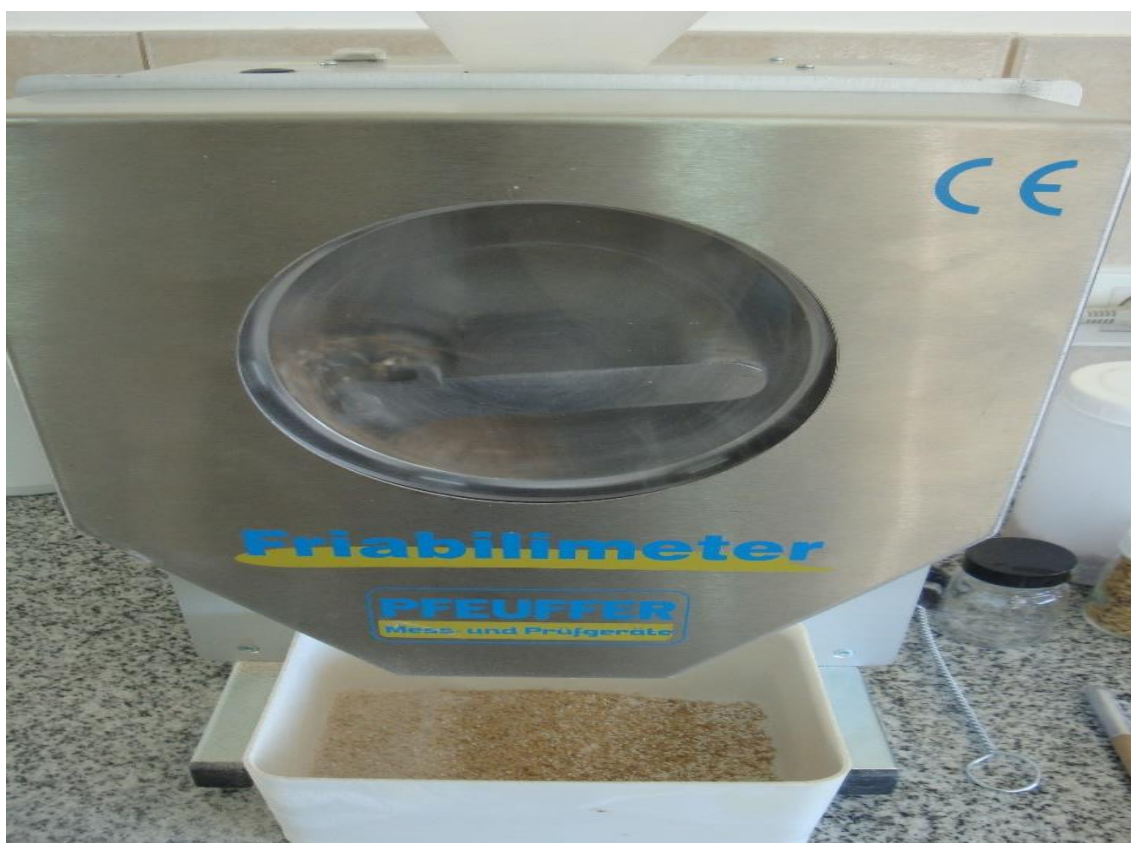
Fig. 19.6. Determinación de friabilidad en malta con Friabilímetro. Laboratorio de Calidad de Cebada y Malta. Mejoramiento y Calidad Vegetal- INTA Estación Experimental Agropecuaria Bordenave. Foto gentileza Dra. Ing. Agr. Verónica Conti.
