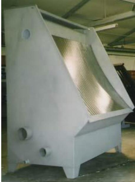
Figura 1.8. Tamiz de rejilla en cuña autolimpiante (Buljan *et al.*, 2012)
