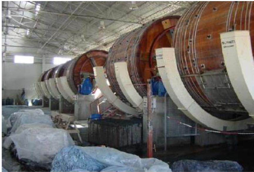
Figura 1.7. Batería de fulones con canaletas colectoras semi-circulares (Buljan *et al.*, 2012)
