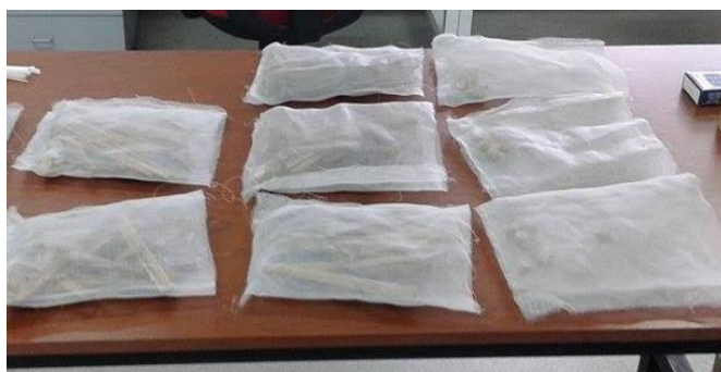
Figura 3.1. Bolsas empleadas en el ensayo, conteniendo el material foliar previo a su posterior sumersión en los sitios de estudio.
