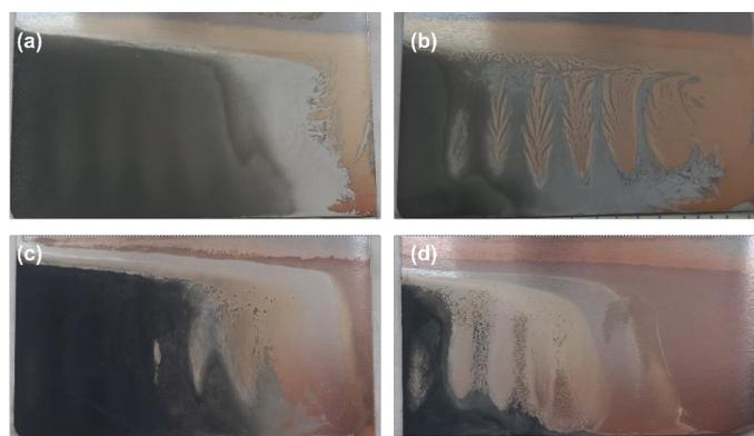
Figura 1. Depósitos en CHE con TU a 50°C a) Cu<sup>2+</sup>=0,065 M y 5 A, b) Cu<sup>2+</sup>=0,065 M y 2 A, c) Cu<sup>2+</sup>=0,13 M y 5 A, d) Cu<sup>2+</sup>=0,13 M y 2 A.
