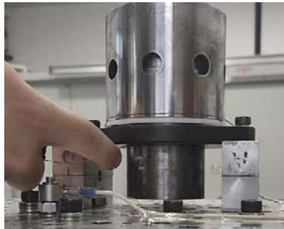
Figura 12 - Verificación de pérdida de estanqueidad mediante galga.
