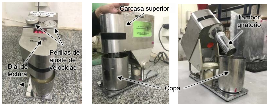
Figura 2. Viscosímetro Multi-Speed 286 marca Baroid ®.
