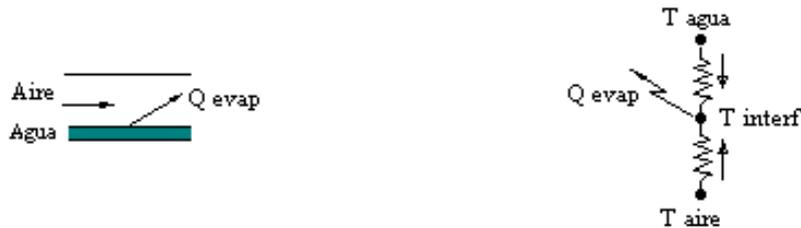
Figura 2: Intercambio de calor sensible y latente en la interfase agua – aire
