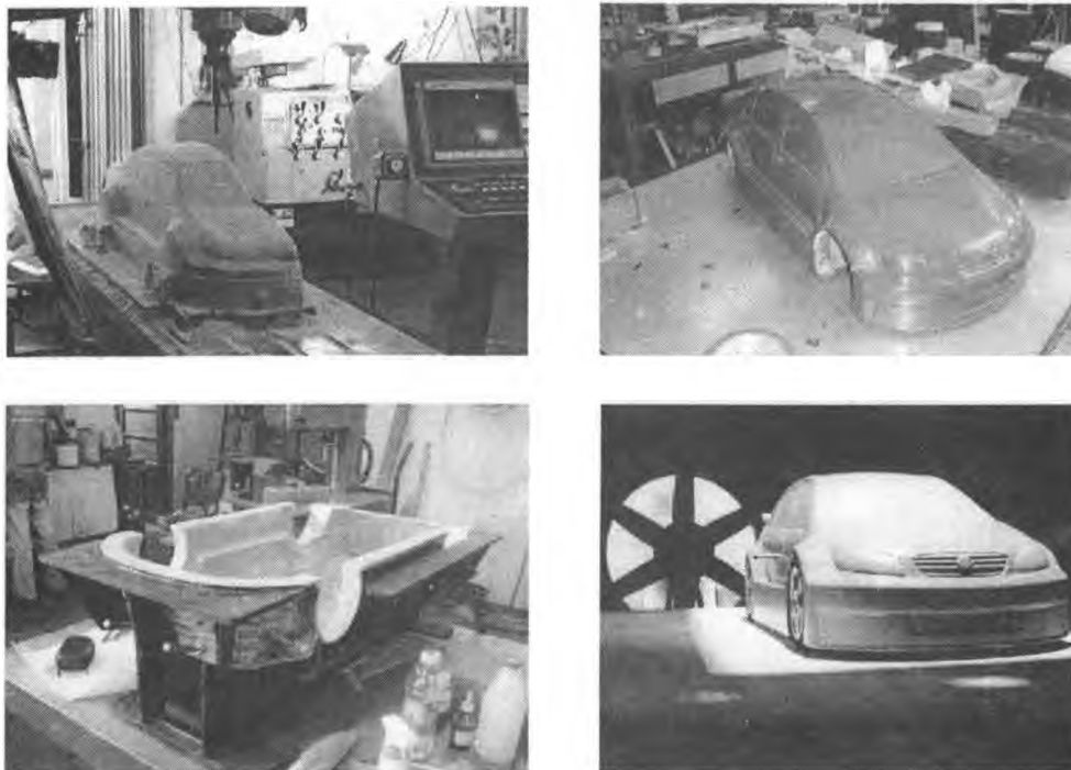
Figura 8: Fabricación del modelo de túnel de viento.
