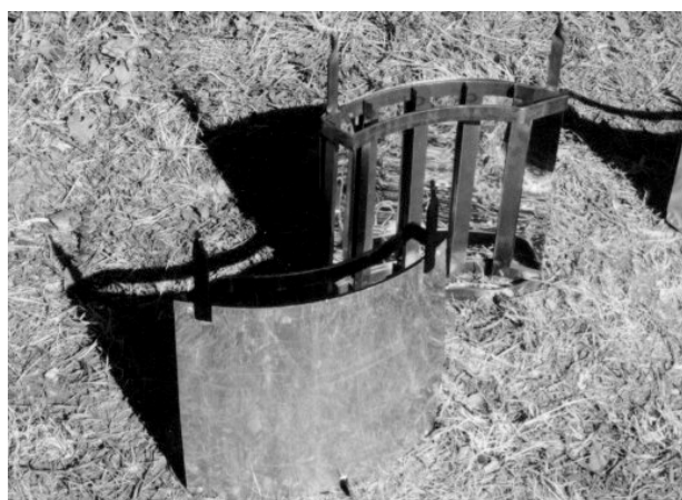
Fig. 4.- Foto de los soportes utilizados para transportar y colocar 5 barras por vez en la olla. Se aprecia la estructura y una lámina de aluminio reflejante que protege al transportador y disminuye las pérdidas.
