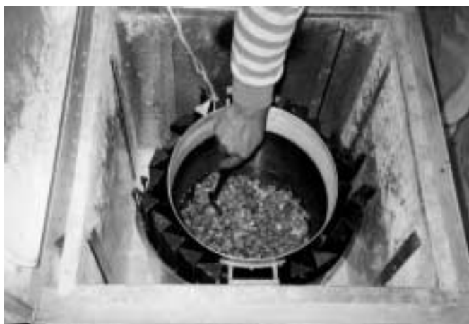
Fig.1.- Foto de una caja caliente con la tapa abierta mostrando la olla y las barras de aluminio que la calientan.
