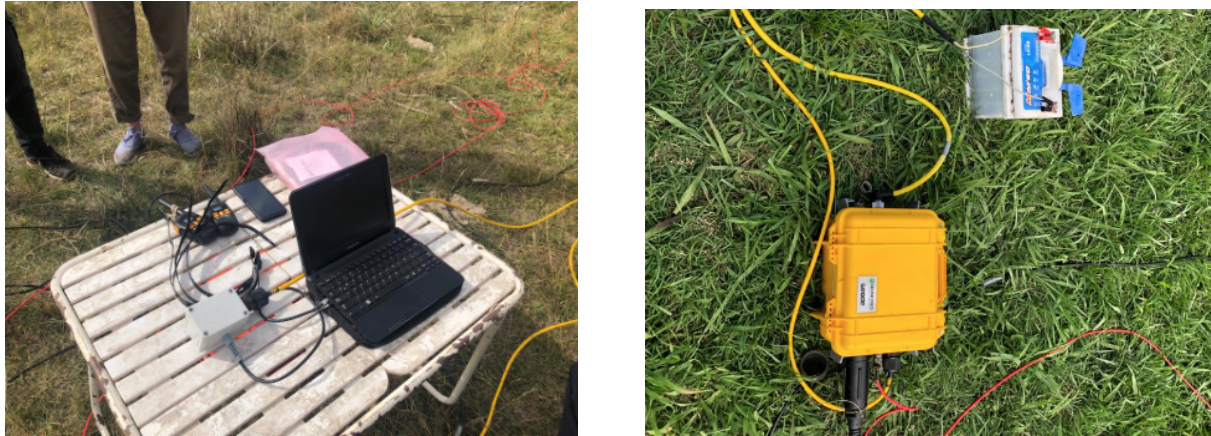
Figura 4.5: Equipo sísmico para el día de la medición. Izquierda: Notebook y conmutador. Derecha: Sismógrafo de exploración Geode y batería.
