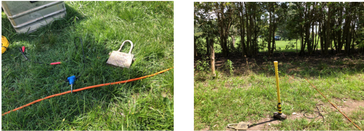
Figura 4.6: Equipo de trabajo para la tomografía sísmica. Izquierda: geófono y plaqueta de aluminio. Derecha: Martillo Geode con plaqueta de aluminio previo a un disparo
