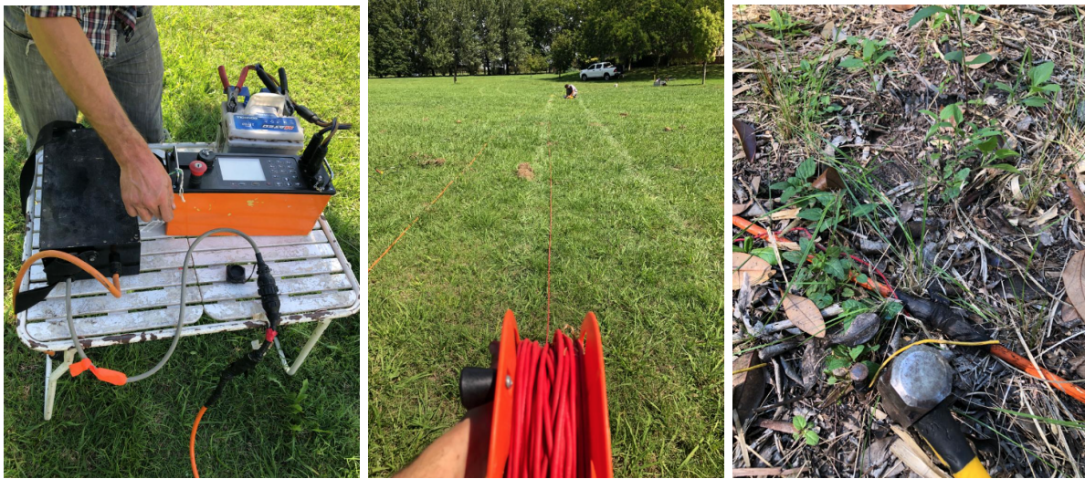
Figura 4.1: Izquierda: Equipo de medición Ares II con conmutador y baterías. Centro: Cable multinúcleo conectado a un electrodo. Derecha: Martillo y electrodo ya clavado en la tierra.
