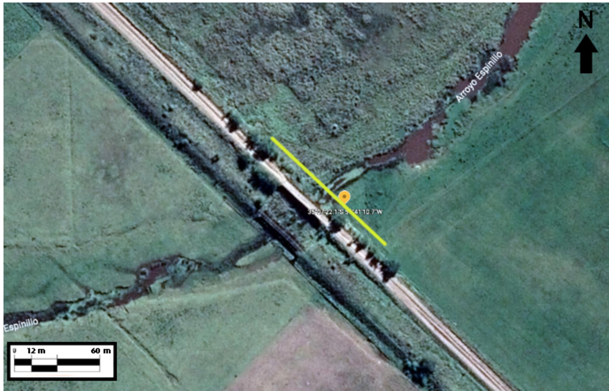
Figura 7.8: Ubicación del relevamiento realizado (imagen satelital de Google Earth). La tomografía se realizó en sentido perpendicular al arroyo Espinillo.
