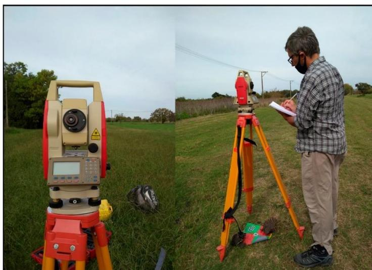
**Figura 10:** Estación Total Kolida®, relevamiento topográfico.
