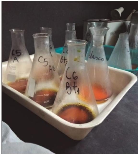
**Figura 9:** Oxidación de la materia orgánica mediante agente oxidante  $K_2CrO_7$  (Dicromato de potasio).
