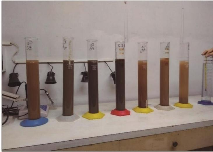
**Figura 7:** Probetas enrasadas posterior a la toma de la primer lectura.
