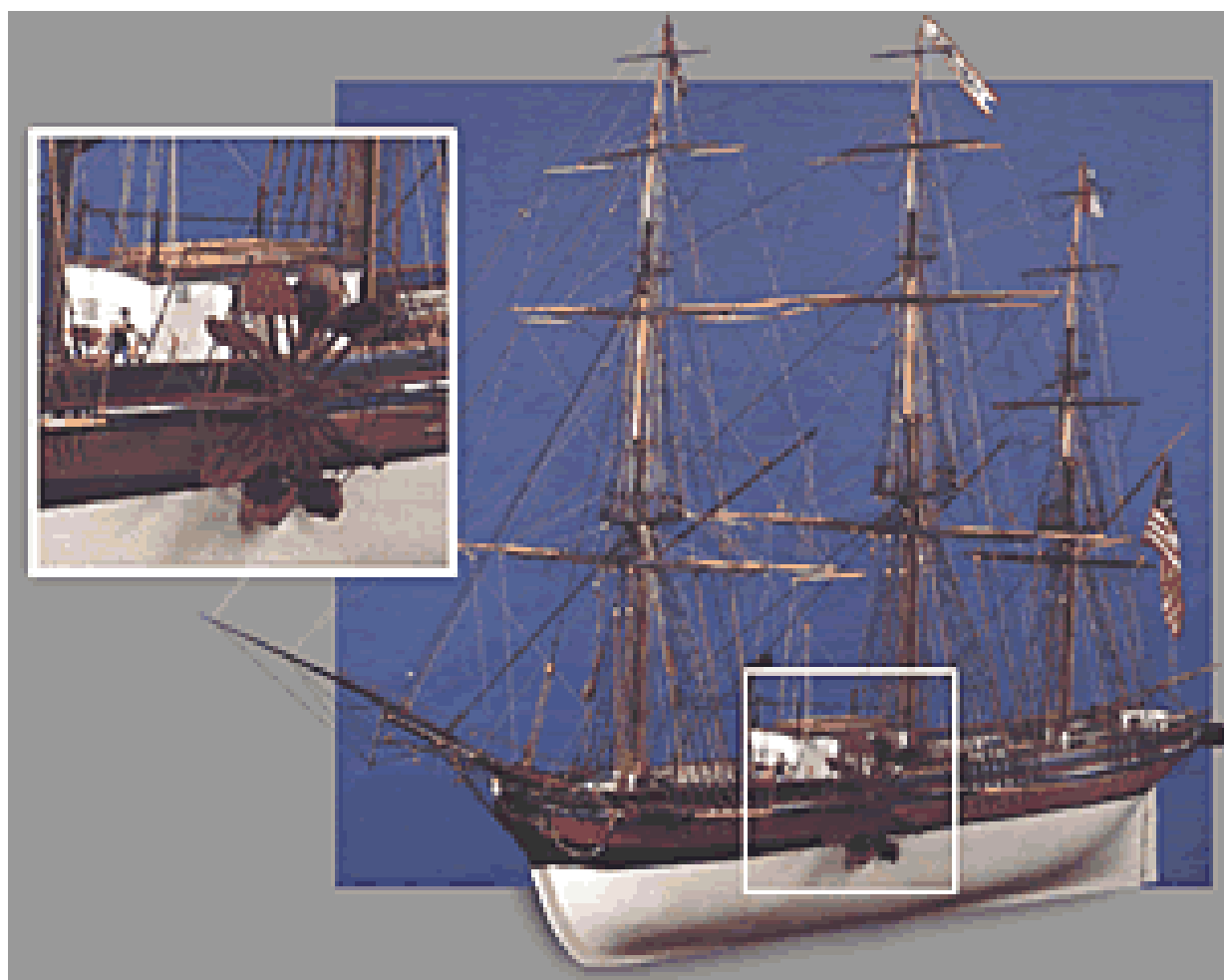
Foto N° 87 : Se observa una maqueta del barco “Savannah”. Nótese el perfil ahusado, junto con el detalle de las ruedas de paletas laterales .-
