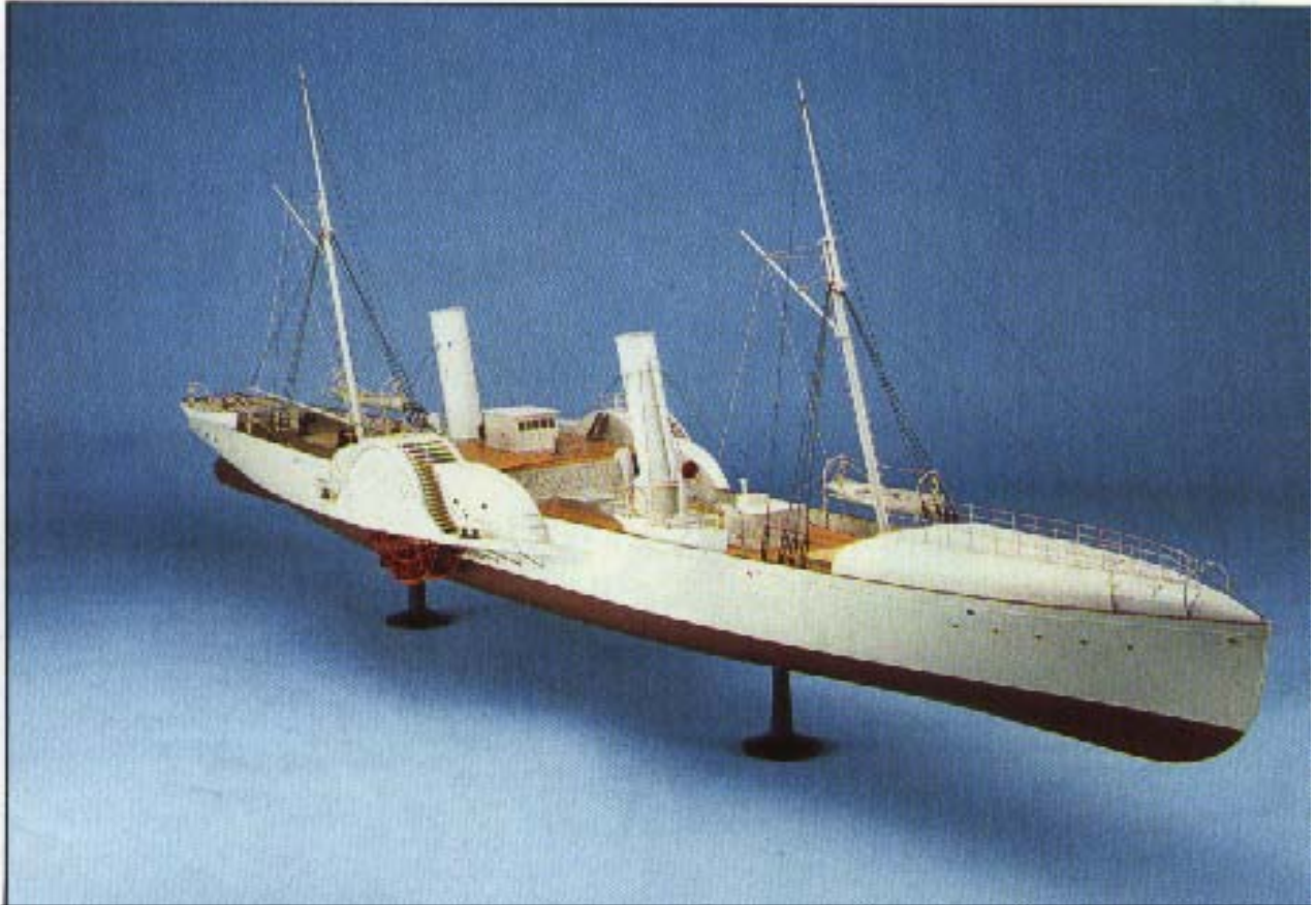
Foto N° 110 : Se observa una maqueta del barco “Hope”. Podemos notar los palos y chimeneas muy inclinados y el castillo de proa curvado en forma de “dorso de ballena”. Dicho castillo fue diseñado para proteger la parte anterior del buque mientras navegara a alta velocidad por aguas turbulentas. Esta característica fue posteriormente perfeccionada .-
