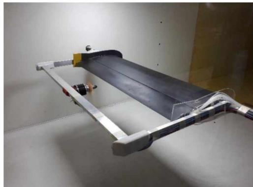
Figura 2: Modelo en túnel de viento.
