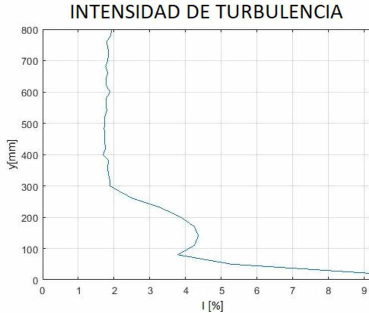
Figura 3: Distribución vertical de intensidad de turbulencia.
