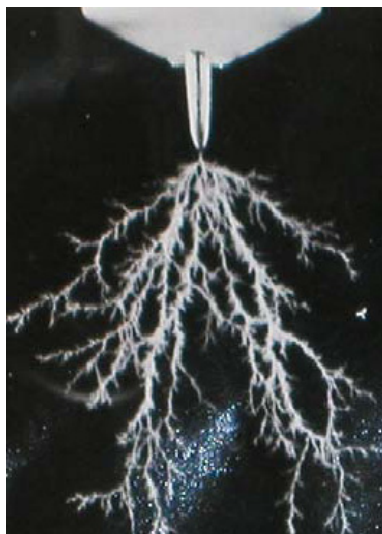
Fig. 2. 5 - Canales eléctricos (arborescencias) en un aislamiento [13]
