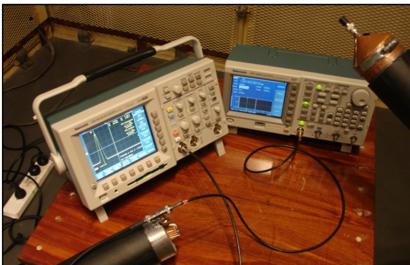
Fig. 4. 32 - TDR con el cable adaptado
