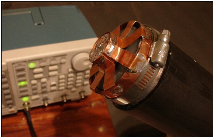
Fig. 4. 36 - Cortocircuito en el extremo opuesto a la inyección de la señal
