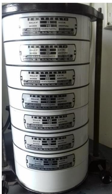
Figura 4.6: Arreglo de tamices usado para la separación por tamaño del ácido bórico.
