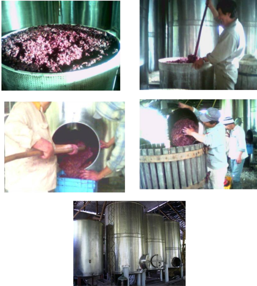
Figura 1.1. Elaboración de vino de la Costa, encubado en tanques de fibrocemento con revestimiento epoxi, bazuqueo, descube con prensas de madera y tanques para clarificación y almacenamiento (fotos en la quinta de Galeán, año 2007).
