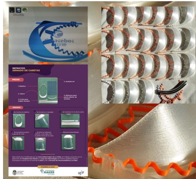
Figura 3: Impresiones del segundo prototipo de máscaras e instructivo. Fuente: Elaboración Propia - Comunidad Makers La Plata - Escuela de Aeromodelismo – UNLP
