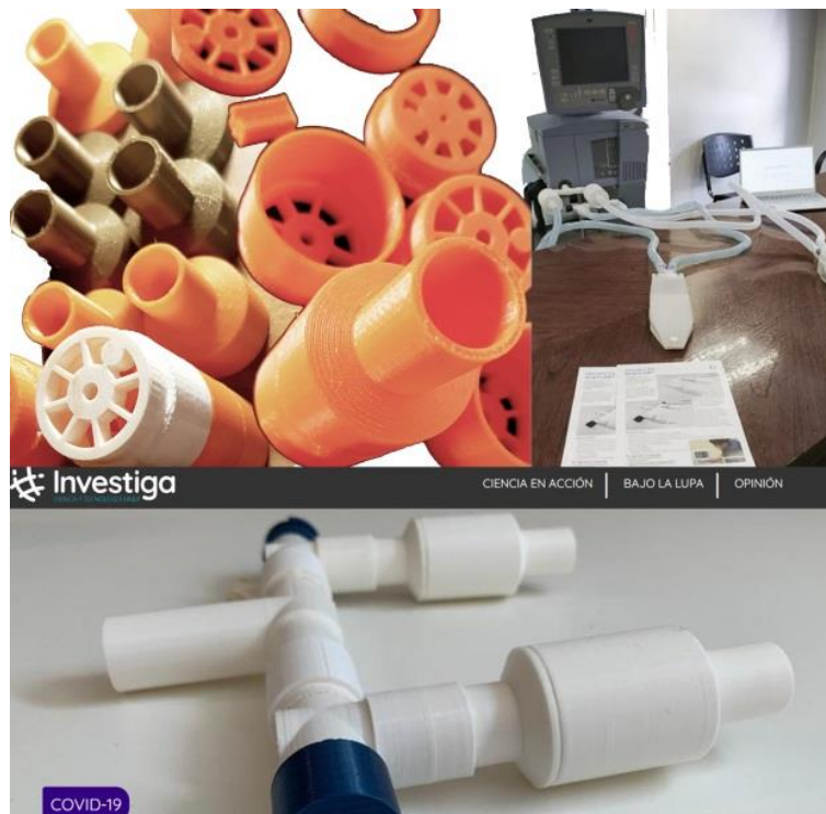
Figura 4: Fotomontaje de impresiones en ABS de piezas para ser sometidas a encastes. Los tubos se incorporaron a respiradores en el marco del proyecto DuplicAR. Fuente Elaboración propia – UNLP Investiga.
