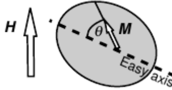
Figura 1: La magnetización \vec{M}(r) no es necesariamente paralela al campo externo \vec{H}_c , a menos que este sea paralelo al eje de fácil magnetización.
