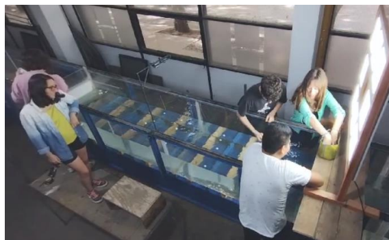
Figura 1.- Ejecución de mediciones PTV en el canal.
