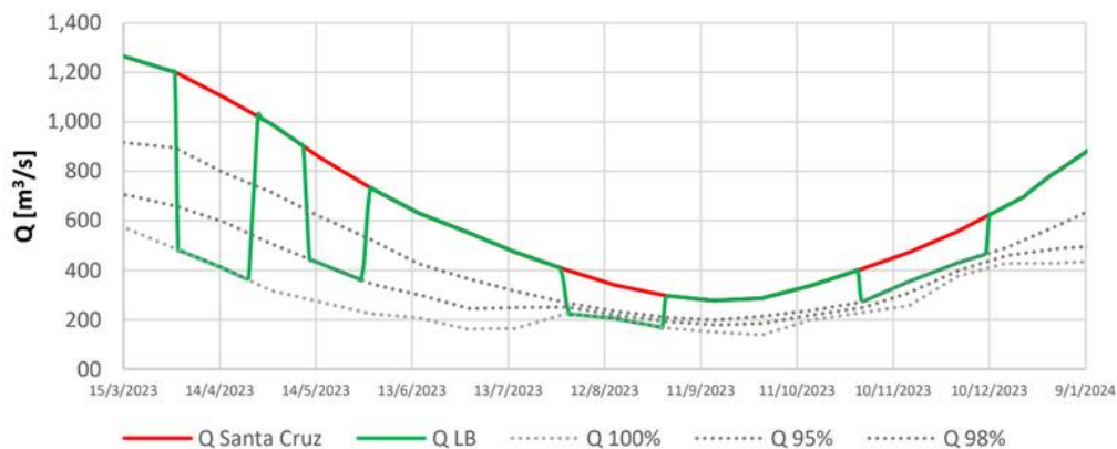
Figura 3.- Hidrograma de un año medio (rojo) y último hidrograma propuesto para el llenado (verde). Las líneas de puntos constituyen, a modo de referencia, hidrogramas sintetizados en base a observaciones de cierto porcentaje de excedencia.
