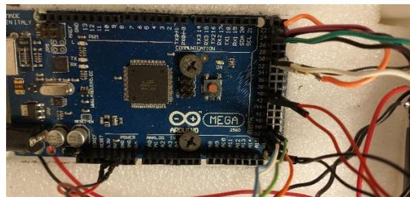
Figura 3: Tarjeta Adquisidora Arduino Mega
