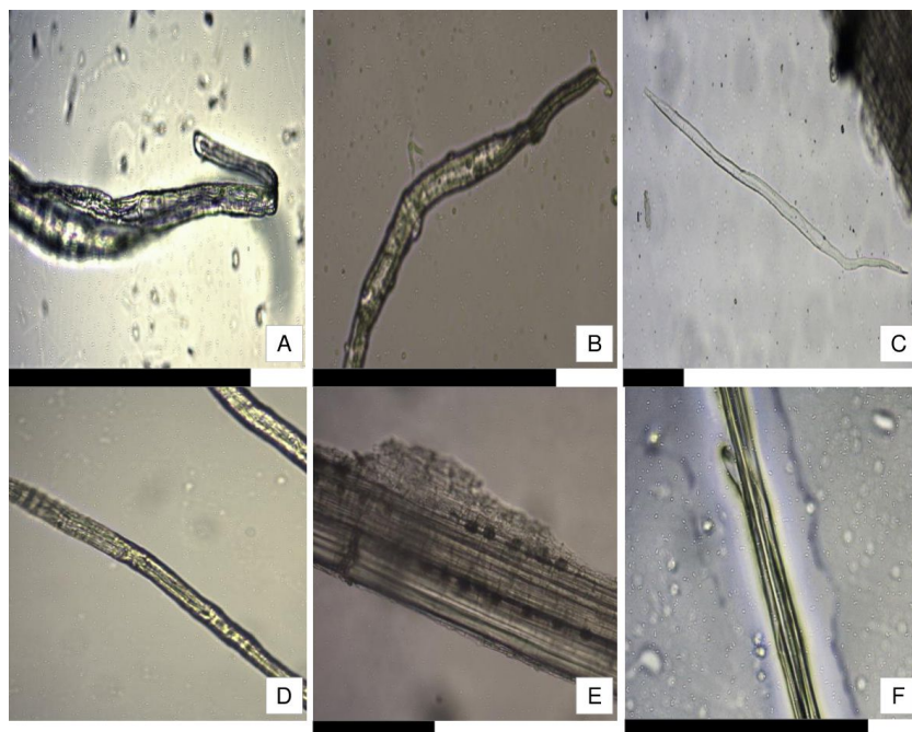
Fig. 5. Comparación entre fibras de “Papel Japón”, Broussonetia sp. y Euonymus sp. Extremos. A: “Papel Japón”. B: Broussonetia sp. C: Euonymus sp. Estriás. D: “Papel Japón”. E: Broussonetia sp. F: Euonymus sp. Escalas = 10 \mu m.
