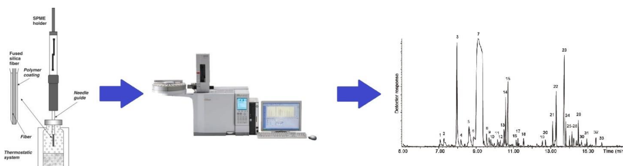
Figura 3.10: Esquema del proceso utilizado para el análisis de AEs.
