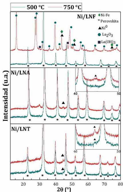
**Figura 1:** Difractogramas de las perovskitas Ni/LNB reducidas
