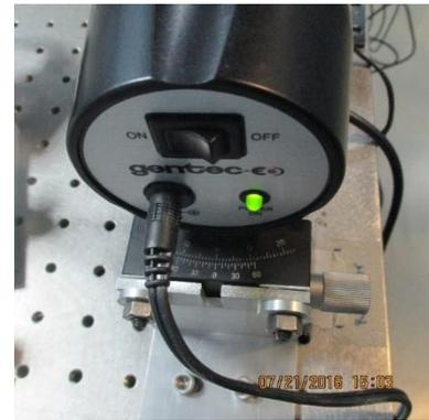
Fig. 7– Montaje del sensor piroeléctrico en el rotador.
