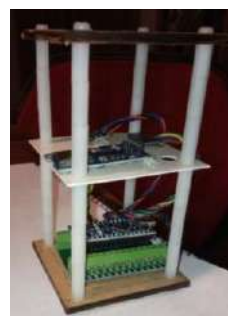
Fig. 1: Esquema de conexión y resultado de la construcción del demostrador tecnológico CanSat.
