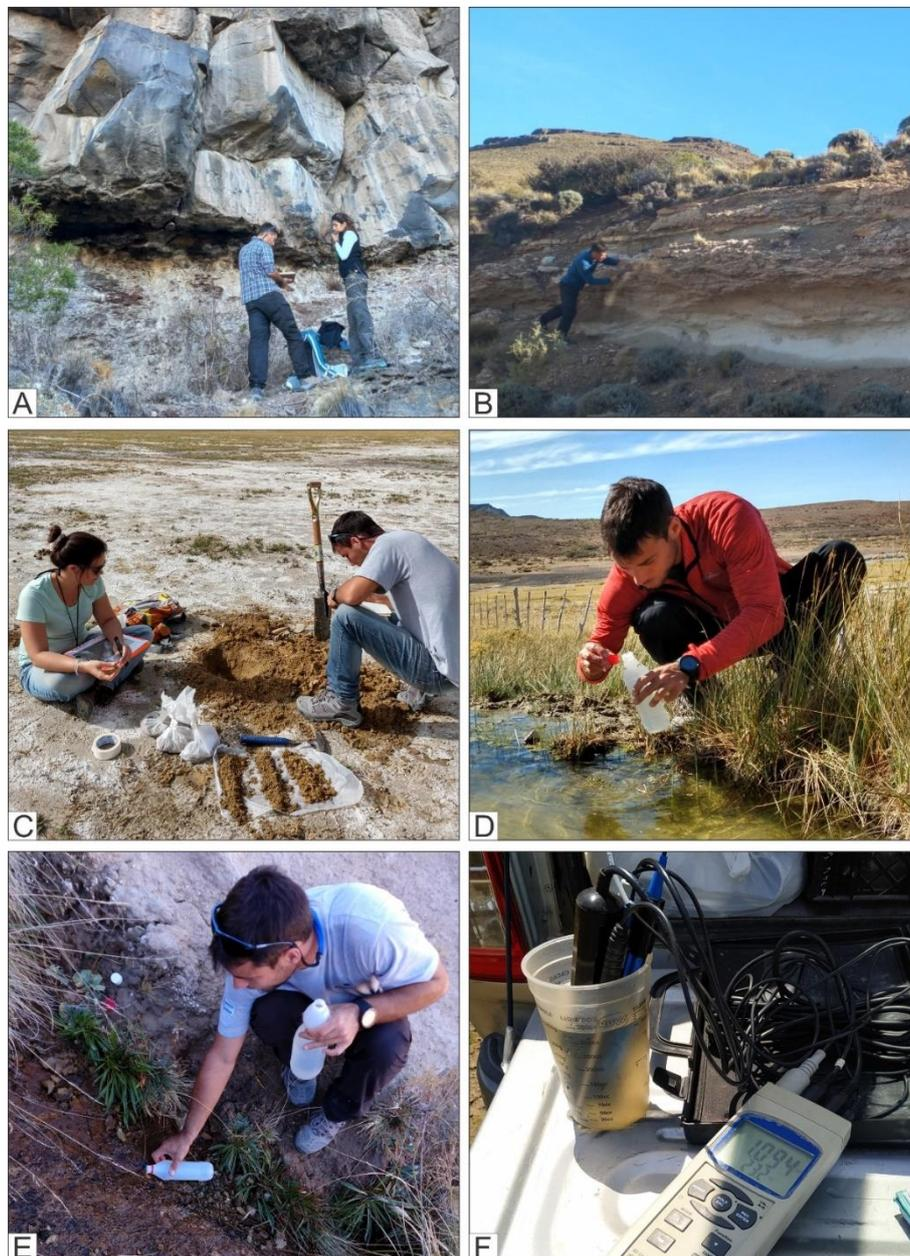
**Figura 2.4.** Fotografías del trabajo de campo realizado: A. y B. Muestreo de agua; C. y D. Muestreo de rocas; E. Muestreo de sedimentos; F. Medición de parámetros físico-químicos in situ mediante equipo manual multiparamétrico.
