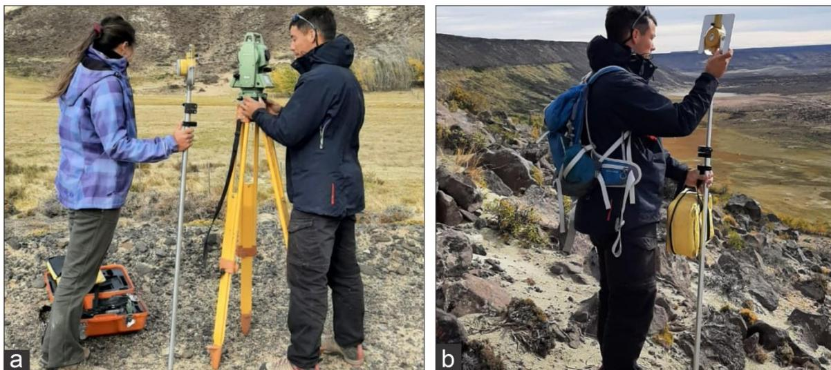
**Figura 2.2.** Utilización estación total. A. Posicionamiento del trípode y de la estación total. B. medición de punto sobre el contacto Grupo Baqueró – Formación Salamanca.
